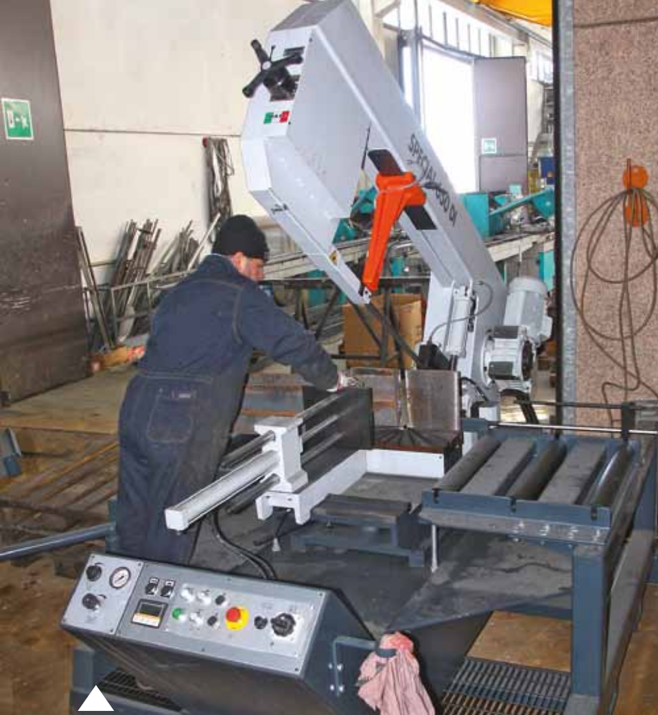
Segatrice a nastro semiautomatica per il taglio di barre piene e profilati di medie e grosse dimensioni
